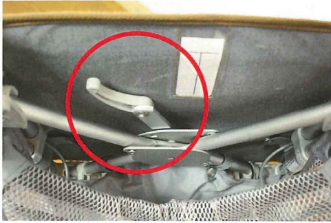
ヘルシーワン レバーが左に行き止まるところまでしっかり倒してください。
